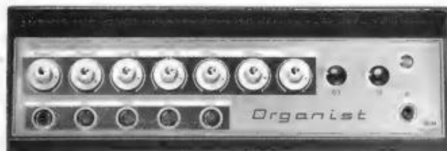
40-W-Gegentakt-Parallelverstärker „Organist“ mit Ultralinear-Ausgangsübertrager
