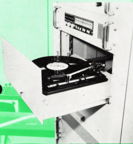
Plattenwechsler für Programmübertragungen in TE 200 .
