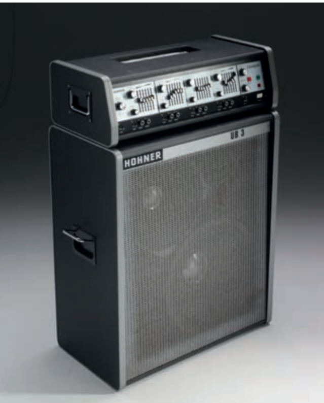
Hohner Champion Röhrenverstärker von 1975 mit 120 Watt: Das aufwendige Bedienpanel bietet eine Mischpultsektion pro Kanal samt Push-Pull-Poti-Belegung, dazu Hall und Vibrato. Als Box dient das Hohner UB1 (Universalbox) Breitbandmodell
