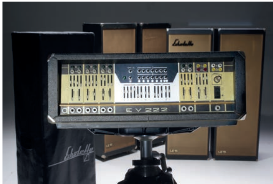
Seltener Transistor-Mischverstärker EV222 von Klemm mit Stereo-Endstufe für getrennt mischbares Original- und Effektsignal des integrierten Bandechos/Halls. Im Hintergrund: Echolette-Gesangsboxen LE5
