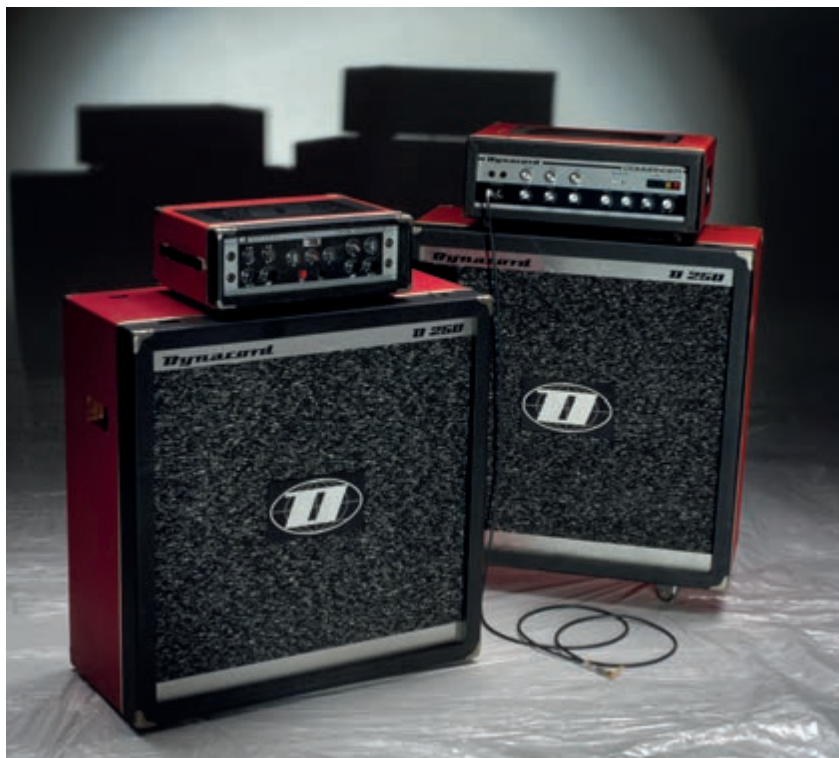
Links: Dynacord Hi-Fi Favorit II Röhrenverstärker aus der Eminent-Serie. Rechts: Commander Universalverstärker aus Transistorvorstufe und mächtiger Röhrenendstufe mit 4x 12 Lautsprecherboxen im Marshall Format
