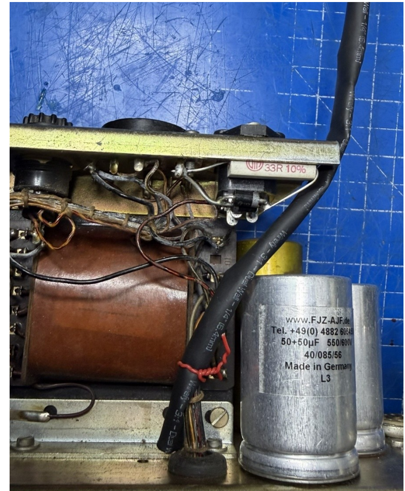
Abbildung 22: Die Anschlussdrähte werden einfach neben der Netzbuchse nach außen geführt
