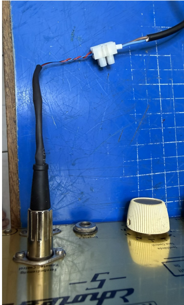
Abbildung 28: Verbindungsmethode über modifizierte Fußschalter-Buchse
