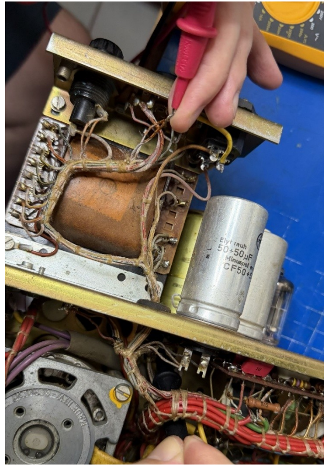
Abbildung 14: Gegenprobe, ob der richtige Draht als A' identifiziert wurde
