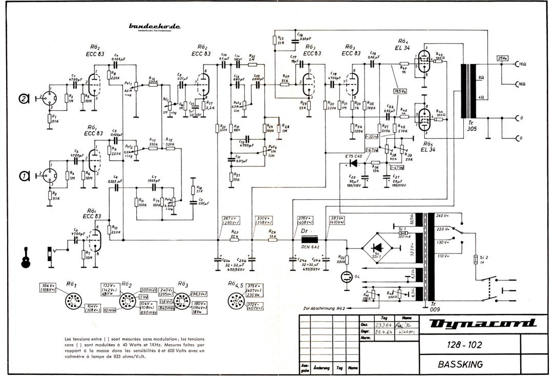
Le circuit des entrées 1 9 et 2 10 est prévu de telle façon, que même les micros dynamiques à basse impédance (200 Ohms) peuvent y être raccordés avec ou sans transformateur de ligne intermédiaire.
