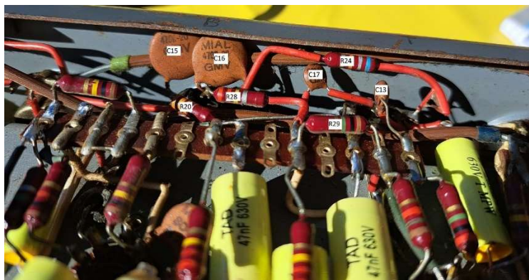
Detail Tone Stack mit Bauteilnummern
