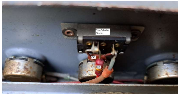
Tone Schalter Gitarre mit Bauteilnummern
