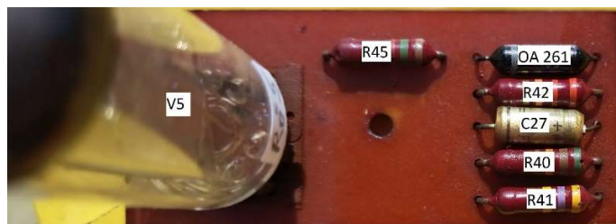
Schaltung Magisches Band mit Bauteilnummern
