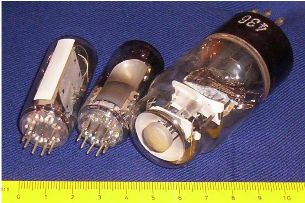
Beispiele für Anzeigeröhren, von links: Mag. Band, Fächer, Auge (Bild aus wiki.utdx.de)
