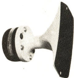
AF R 1 T Hochton-Kammersystem 10 Watt Nennleistung, Übertragungsbereich 1 kHz bis 20 kHz Impedanz: 16 Ohm Gewicht: 0,9 kg Schallaustrittsöffnung 145 x 67 mm
