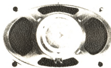
P 285 Länge 285 mm, Breite 180 mm Magnet 11 000 Gauß, Schwingspule 2,7 Ω
