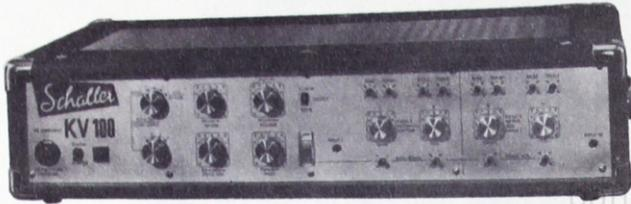
Dieses Steuergerät enthält 2 Verstärker mit je 60/80 W Endleistung und außerdem noch das Echo-Sound-Studio. Das Gerät kann als Solisten-Verstärker genau so gut eingesetzt werden wie als Gesangs-Anlage, dabei brauchen nur die Lautsprecher dem Verwendungszweck entsprechend angepaßt werden.
