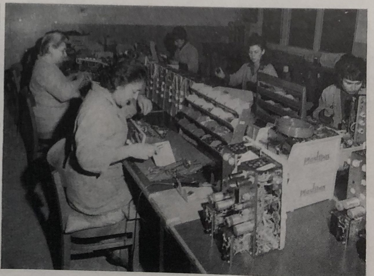
Fertigung der Gehäuse für Echolette-Orchester-Verstärker (links) — Ein Blick in die Fertigungsabteilung bei Klemt — Assembly of the casings for Echolette orchestra-amplifiers — (lefthand) view of the Klemt assembly-workshop — Examen technique au moyen d'appareils de mesure spéciaux d'un appareil de réverbération Echolette (à gauche) — Examen des amplificateurs par le courant de haute tension.
