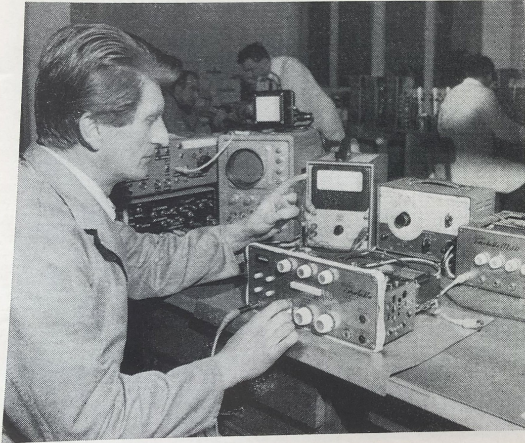
Meßtechnische Überprüfung eines Echolette-Hallgerätes (links) – Verstärkerprüfung mit Starkstrom (rechts) – Control testing of an Echolette reverb-unit (lefthand) – Testing amplifiers with high-voltage current (righthand) – Le finissage des caisses qui vont contenir des amplificateurs Echolette pour orchestre (à gauche) – Un coup d’œil dans la section du finissage chez Klemt. Werkfotos: Echolette-Vertrieb, München
