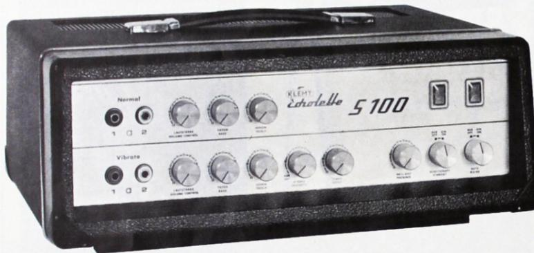
Gitarrenverstärker mit massiver Röhren-Gegentakt-Endstufe. – Sinusleistung: 65 Watt. Musikleistung: 100 Watt.
