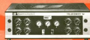
**EMINENT 100 SOLID STATE**, volltransistorisierter 6-Kanal-Gesangs-Mischverstärker, 7 Eingänge, eingebautes Bandhallgerät in Mischpulttechnik mit Schieberegler, Echoreturn-Steller, VU-Meter, Polyamid-Schaumgehäuse; **Leistung: 110/80 Watt**, Ausgang 2x 4 Ohm, Monitor-, Kopfhörer- und Steuerausgang, 565 x 108 x 475 mm (BxHxT).
