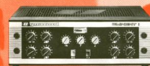
**GIGANT II**, 6-Kanal-Gesangs-Großmischverstärker, in Mischpulttechnik mit Schieberegler, 8 Eingänge, Kanal- und Summenregelung, Anschluß für Hallgerät, VU-Meter, Monitoranschluß; **Leistung: 200/150 Watt**, Ausgang 4x 4, 2x 8, 1x 16 Ohm, Steuerausgang, 100 V, 550 x 230 x 550 mm (BxHxT), Gewicht 27 kg.
