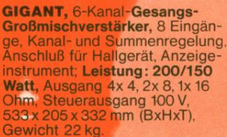
**GIGANT**, 6-Kanal-Gesangs-Großmischverstärker, 8 Eingänge, Kanal- und Summenregelung, Anschluß für Hallgerät, Anzeigeelement; **Leistung: 200/150 Watt**, Ausgang 4x 4, 2x 8, 1x 16 Ohm, Steuerausgang 100 V, 533 x 205 x 332 mm (BxHxT), Gewicht 22 kg.
