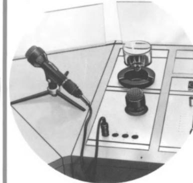
Für den Disc-Jockey-Service enthält dieses Feld eine Halterung für ein Glas und einen Aschenbecher; das Ansagemikrofon kann versenkt abgelegt werden. Weiter sind Anschlußbuchsen für Zusatzmikrofon, Kopfhörer und Tonbandgerät eingebaut. Ein Mikrofonstativ zur Befestigung des Zweitmikrofon steht ebenfalls zur Verfügung.
