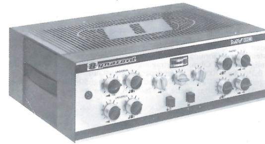
**MV 80 110/80 Watt-Mischverstärker für Übertragungsanlagen DM 1026,75**
