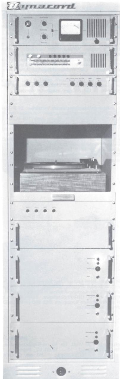
Gestellsschränke in 19-Zoll-Bauweise eignen sich hervorragend zur zentralen und übersichtlichen Zusammenfassung von zu ELA-Anlagen gehörenden Bausteinen. Zum Beispiel Vorverstärker, Endverstärker, Schalt- und Bedienfelder, Rundfunkgeräte, Tonbandgeräte und Plattenspieler. Zusammenstellung div. Anlagen auf Wunsch, Angebote auf Anfrage.
