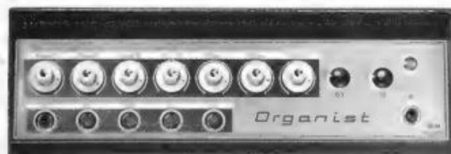
40-W-Gegentakt-Parallelverstärker „Organist“ mit Ultralinear-Ausgangsübertrager
