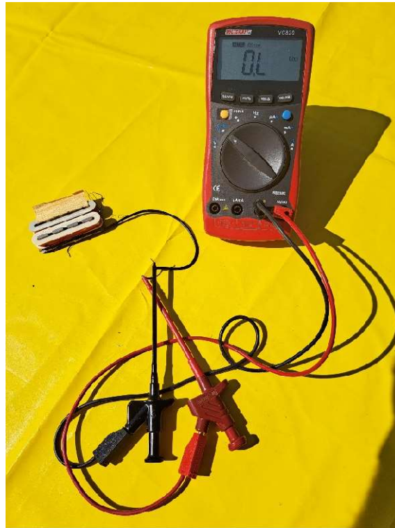
Der Pickup hat eine unterbrochene Spule
