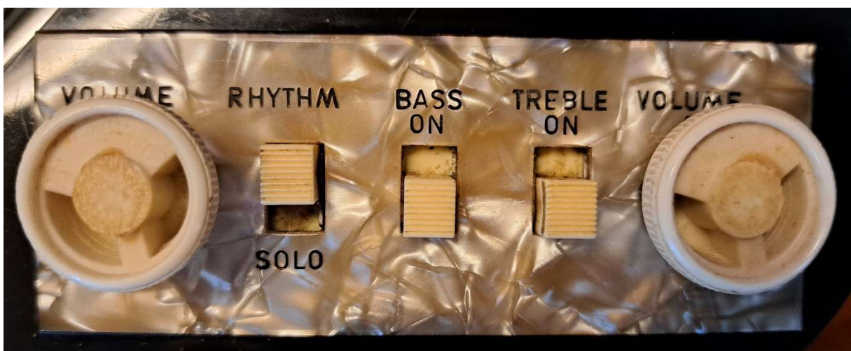
Das Höfner 182 Control Panel (hier sind beide Pickups eingeschaltet!)
