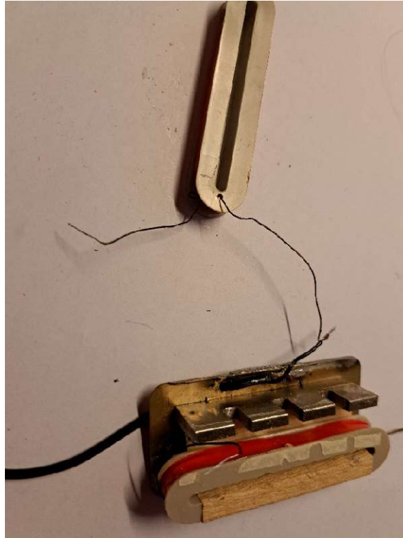
Der geöffnete Bridge PU mit defekter Spule (oben)
