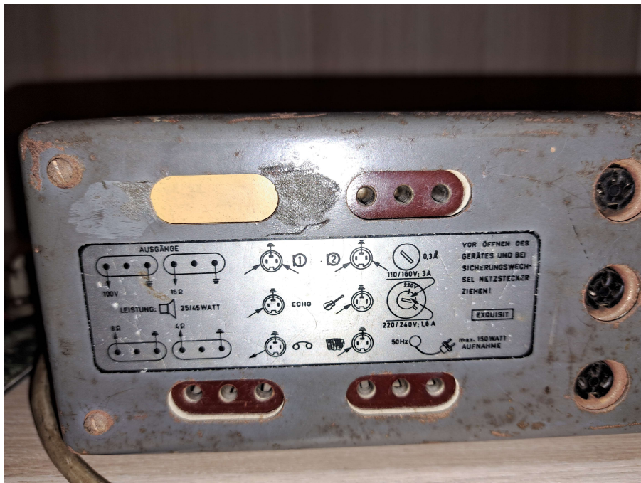
Anschlussplan und Lautsprecherausgänge (mit abgeklebtem 100 V Ausgang)
