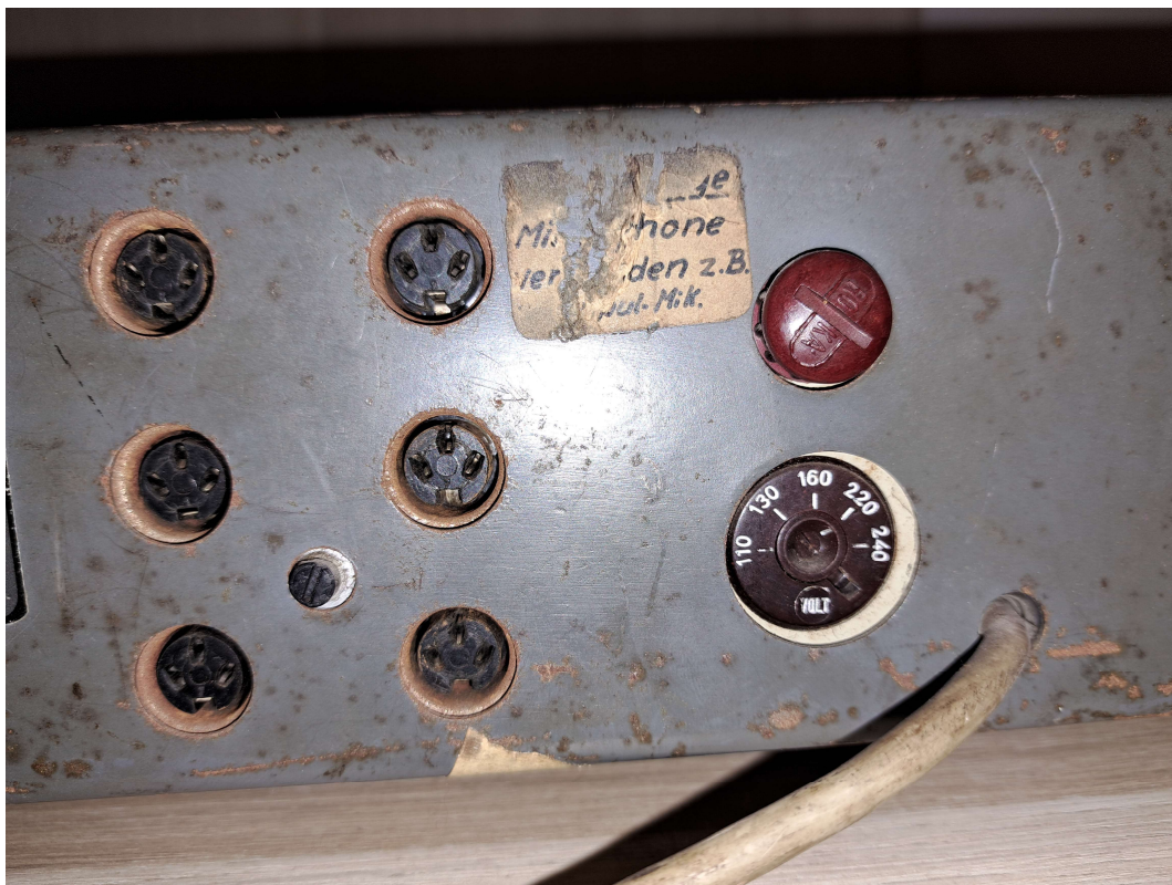
Anschlussbuchsen, Sicherung und Spannungswähler
