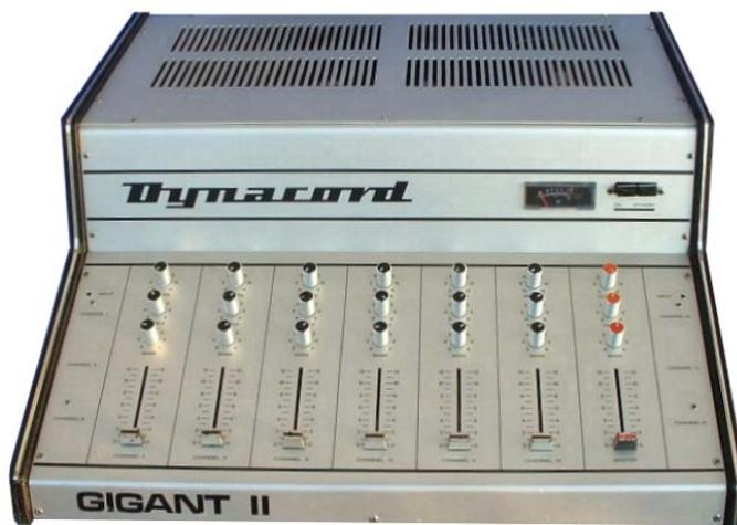
Als überarbeiteter Nachfolger vom GIGANT erscheint im Jahr 1972 der GIGANT II im neuen Gewand als Mischpult-Verstärkers im edlen Metall-Look. Für die Volume-Einstellungen werden jetzt moderne Flachbahnschieberegler aus der Studioteknik eingesetzt. An der elektrischen Schaltung wurden einige Änderungen gegenüber dem Vorgänger vorgenommen.
