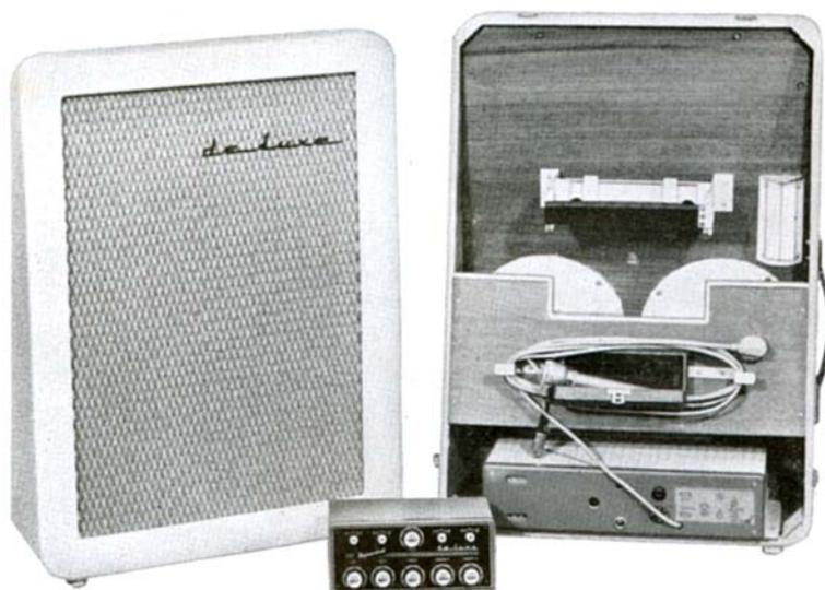
Dynacord kommt mit der Herstellung einer kompletten Verstärkeranlage den Wünschen nach einem hochwertigen und speziellen Mischverstärker für den Einsatz in modernen Tanzorchestern nach.
