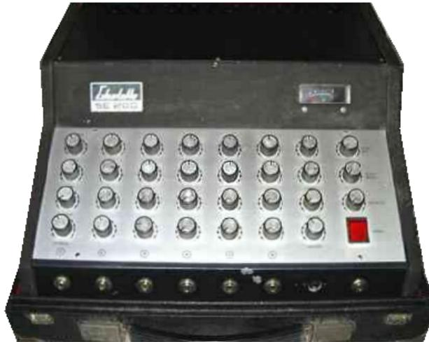
Dieser neue volltransistorierte Powermixer in Mischpultform wird unter dem Label von Echolette vermarktet, aber bei Dynacord produziert. Er entspricht schaltungstechnisch in etwa dem Eminent 100, es wurde jedoch ein von der technischen Ausstattung her einfacheres Echo-Hallgerä eingebaut. Mit 6 mischbaren Universaleingängen ist es ein günstiges Einsteigermodell für kleinere Bands
